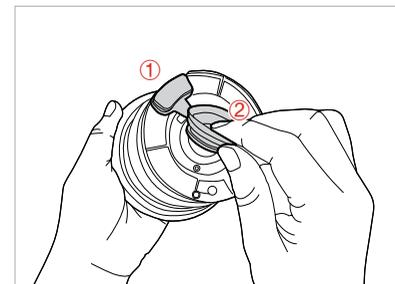
Die Silikonringdichtung lässt sich zur Reinigung abnehmen. Setzen Sie die Dichtung wie auf dem Bild gezeigt wieder ein, achten Sie dabei auf korrekten Sitz.
